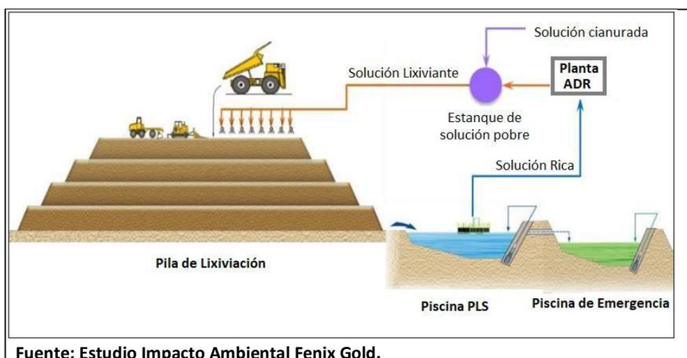
La lixiviación del mineral se llevará a cabo mediante el método de lixiviación en Pila estática con solución de cianuro, con un sistema de drenaje, una Piscina de PLS (*Pregnant Leach Solution*), una Piscina de Emergencia (PE) y un sistema de bombeo de soluciones y riego de
